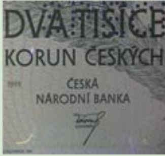
text “DVA TISÍCE KORUN ČESKÝCH, ČESKÁ NÁRODNÍ BANKA” and author’s name “O. KULHÁNEK INV.” do not fluoresce
